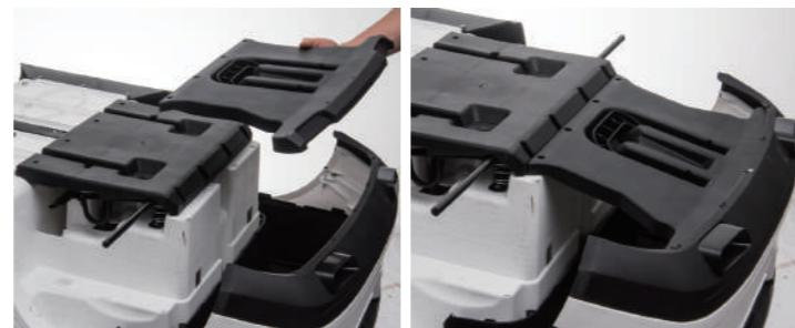
Okrenite vozilo naoako. Uklonite stabilizator, postavite drzac branika a zatim ga usrafite.
